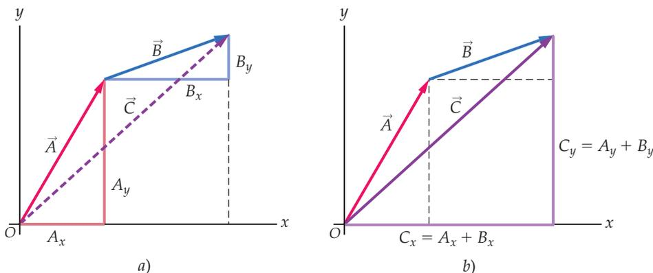
▲ **FIGURA 14** Somma di vettori mediante le componenti
